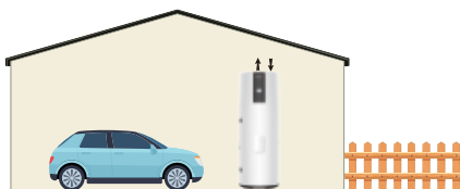
Installation in einem unbeheizten Raum >15m 2
