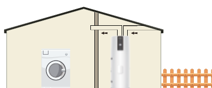
Installation mit 2 Kanälen nach außen
