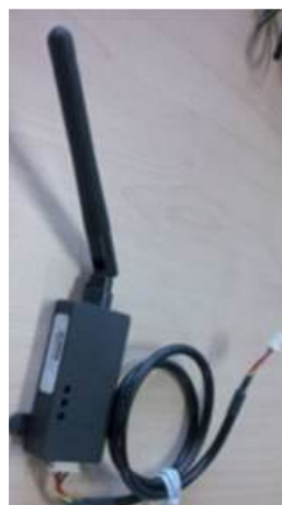
Funktadapter für die Inneneinheit, die an die jeweilige elektronische Platine angeschlossen werden soll.
