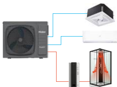
Szenario 5: Häusliches Warmwasser + AC Kühlung
