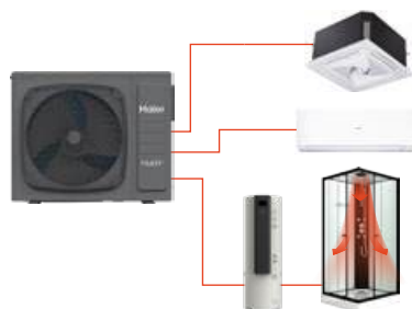
Szenario 2: Häusliches Warmwasser + AC Heizung
